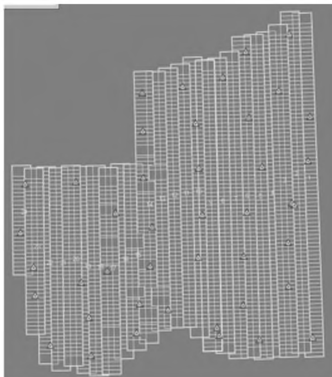
Рис. 7. Расположение 43 опорных точек
