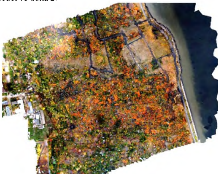
Рис. 3. Ортофотоплан, полученный по результатам беспилотной АФС
