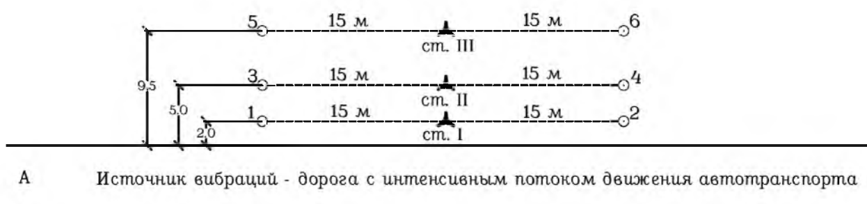
Рис. 1. Схема выполнения экспериментальных работ по определению влияния вибраций на точность определения превышений
